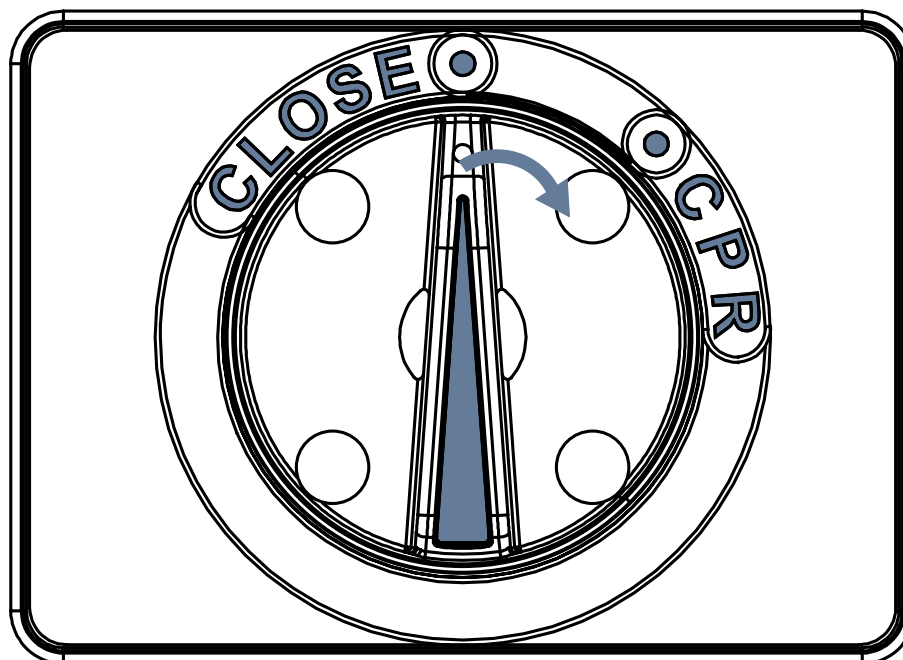
Fig. Réglage du bouton CPR pour l'activation du mode CPR
