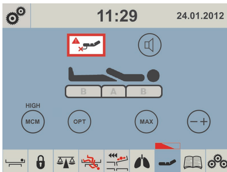
Afb. Waarschuwing – Losse luchtslangen
