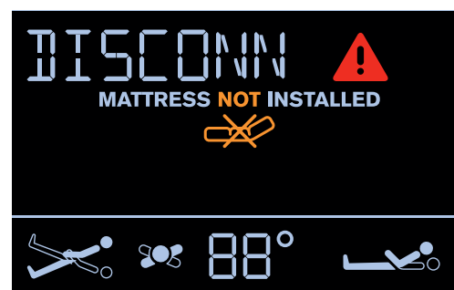
Fig. POMPA SCOLLEGATA
