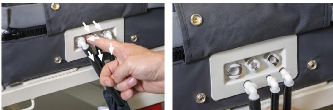
Fig. 9 Scollegamento delle condutture d'aria dal materasso con modalità MCM
