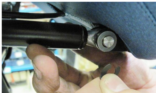
Schema di connessione dell'occhiello della molla a gas e dell'occhiello allo schienale
