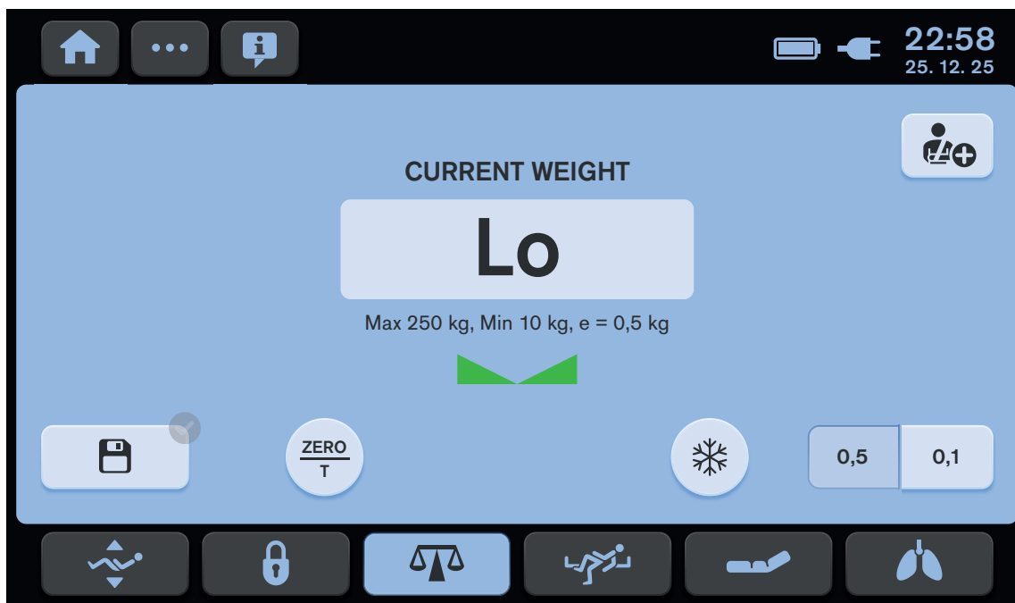
Afb. Onderbelast bed (Lo wordt weergegeven)
