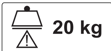
Afb. Veilig draagvermogen van de katrol
