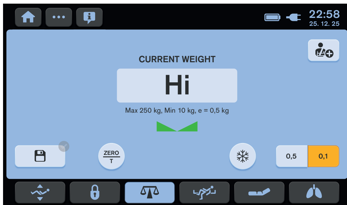
Afb. Eerste graad van overbelasting van het bed (Hi wordt weergegeven)
