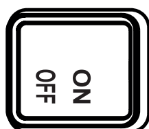
Afb. i-Drive Power-hoofdschakelaar met label
