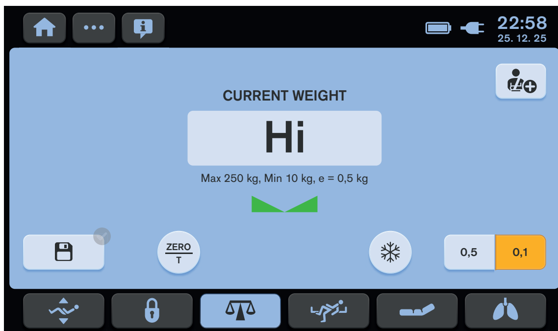
Fig. Primer grado de la cama sobrecargada (visualizado Hi)
