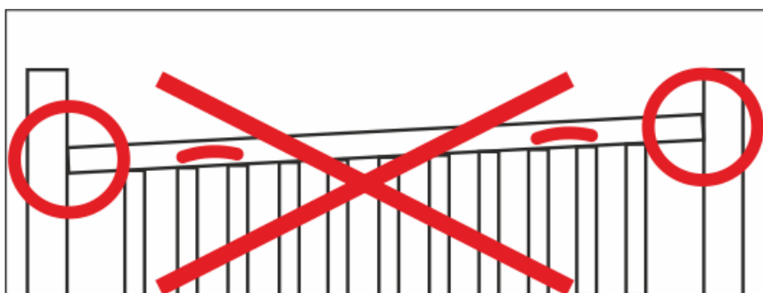
Fig. Trilho lateral incorretamente travado
