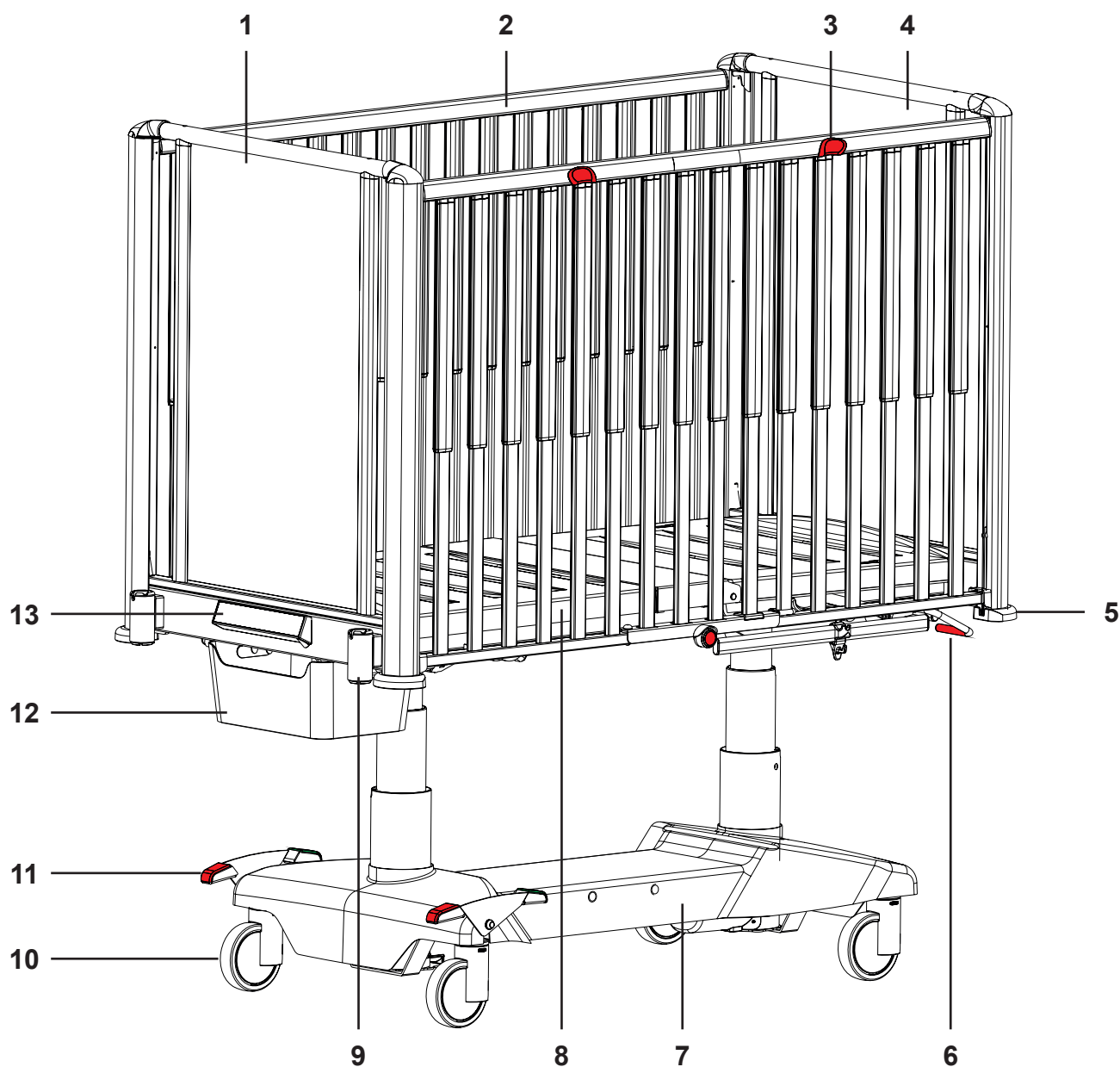
Afb. Overzicht Tom 2 – telescopische zijrails met vaste beddeindes
