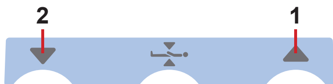
Fig. Pedais de ajuste da altura da cama
