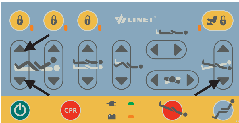
Fig. Desativação da bateria (Painel de controle do assistente)
