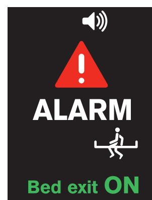
Fig. Señalización visual de alerta de salida de la cama (iBoard Basic)
