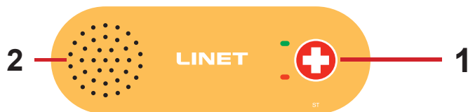
Fig. Elemento de control de la llamada a enfermería (parte interior de la barandilla superior) - versión 2
