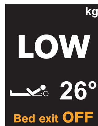
Fig. Subcarga de la cama (iBoard Basic)
