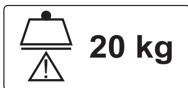
Fig. Carga de funcionamiento seguro de la polea
