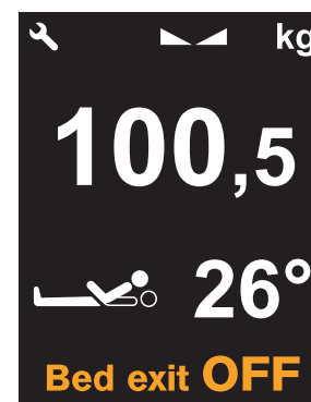
Fig. Surveillance de sortie du lit OFF (désactivée) (iBoard Basic)
