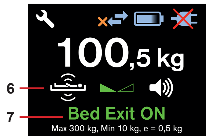
Fig. Description des indications à l'écran (notifications du système d'alarme de sortie de lit)
