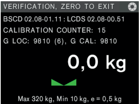
Fig. Pantalla de verificación
