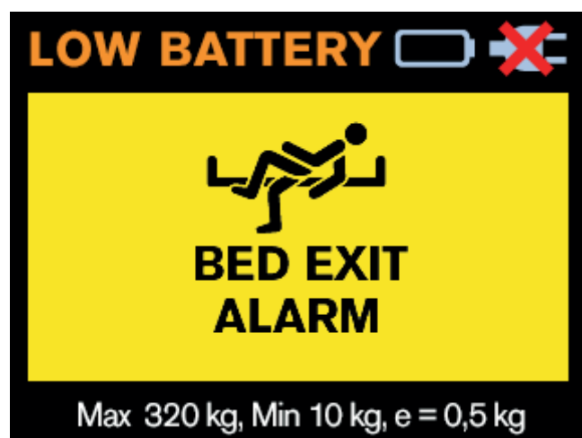
Fig. Segnalazione visiva dell'allarme uscita letto sul display (campo giallo con simboli neri)
