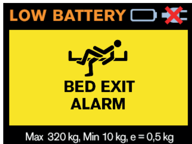
Fig. Signalisation visuelle de l'alarme de sortie de lit sur l'écran (champ jaune et symboles noirs)
